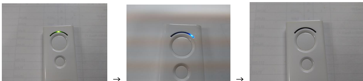
図10:Cyclops2 の LED 点滅パターン
